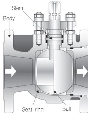
Valve 본체 내에 유로로서 관통 구멍을 가진 Ball을 넣고 회전시키는 형식의 Valve이다. 차단 성능은 Soft Seat의 경우는 대단히 양호하며, 완전 차단이 가능하다. Metal seat는 내열성이 우수하지만 차단성능은 Soft Seat에 비해 떨어진다. 제어용으로 사용하는 Ball Valve는 V-Notch를 넣은 부분을 구체로 하여 특성 개선을 도모하고 있다.
