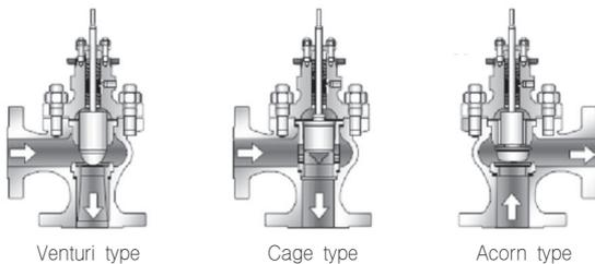
향 전환하며, Slurry유체 · 점성유체 등이 쉽게 흐르게 하는 것을 목적으로 하는 용도에 사용 또는 출구 측에 Drain이 허용되지 않는 경우에 사용한다. 내부구조는 Globe Valve와 거의 같고 Single seated type, Cage type이 있으며, Globe Valve에 비하여 와류현상과 압력 손실이 적다. 따라서 유체 압력 차가 큰 곳에 사용한다.
