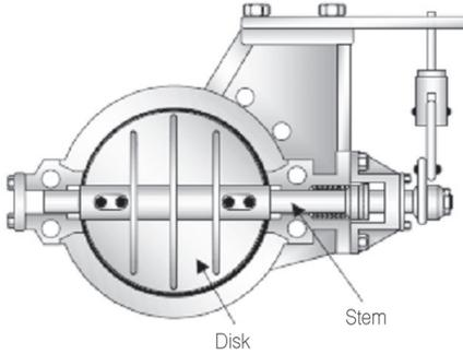
Valve 본체 내에서 Disc가 회전하여 개폐하는 형식의 대표적인 Valve다. 비교적 얇기며 대구경, 낮은 차압에 적합하다. 유체압력에 의하여 움직이는 Torque는 70도 부근에서 최대가 되며, 그 위치를 초과하면 급격히 감소한다.
