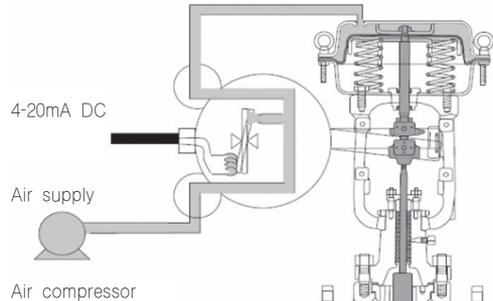
Air가 Compressor에서 공급을 받고 있는 상태에서 전기신호 또는 공기신호를 전달 받아 Positioner를 통하여 Actuator에 Air를 공급함으로써 전달된 힘이 이용하여 Valve의 개폐를 작동시킨다.
